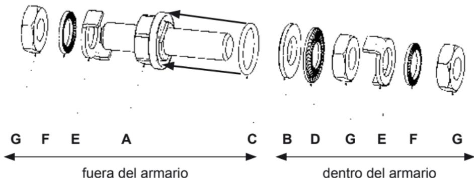
**A** 1 perno de conexión a tierra M10
